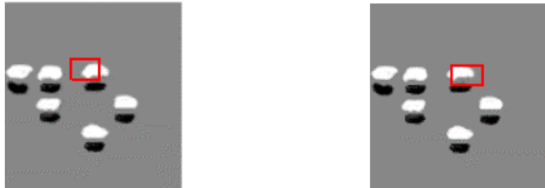
En el caso de la imagen de la izquierda, el borde derecho del rectángulo contiene píxeles blancos. En el caso de la otra imagen los bordes superior e izquierdo contienen píxeles blancos.
